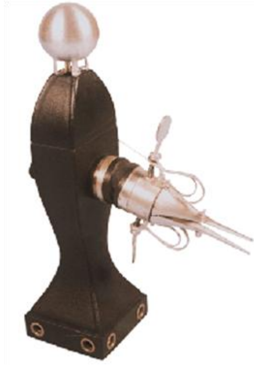
Fig. 7: Endoscopio según Bozzini
