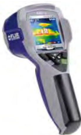
Fotografía MM.15.- Cámara termográfica ThermaCam.
