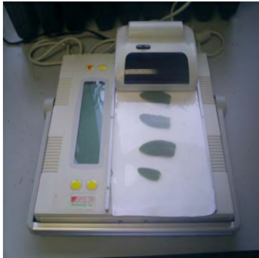
Fotografía MM.3.- Medidor de área foliar AM 200.
