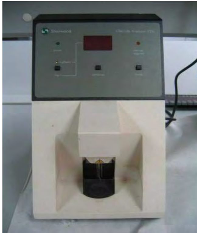
Fotografía MM.6.- Analizador automático de cloruros modelo 926.
