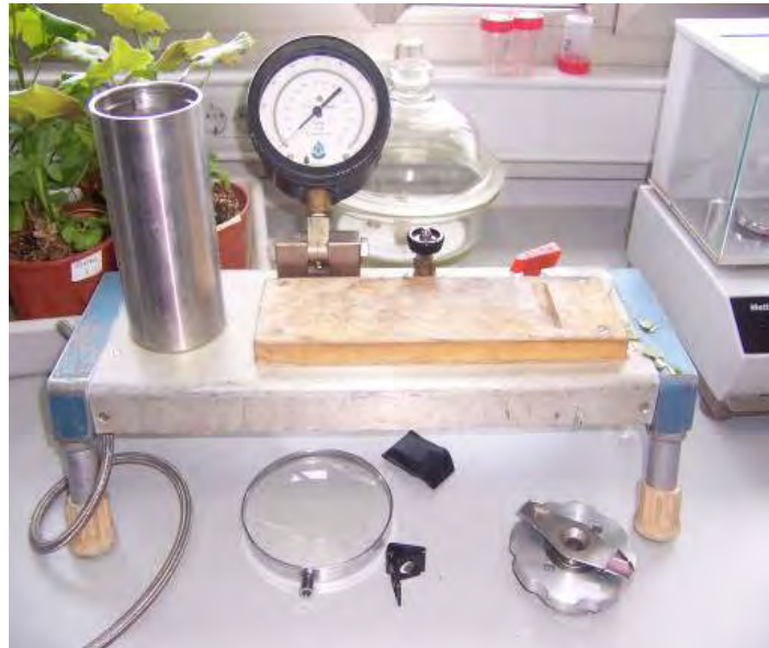
Fotografía MM.9.- Cámara de presión Soil Moisture mod. 3000
