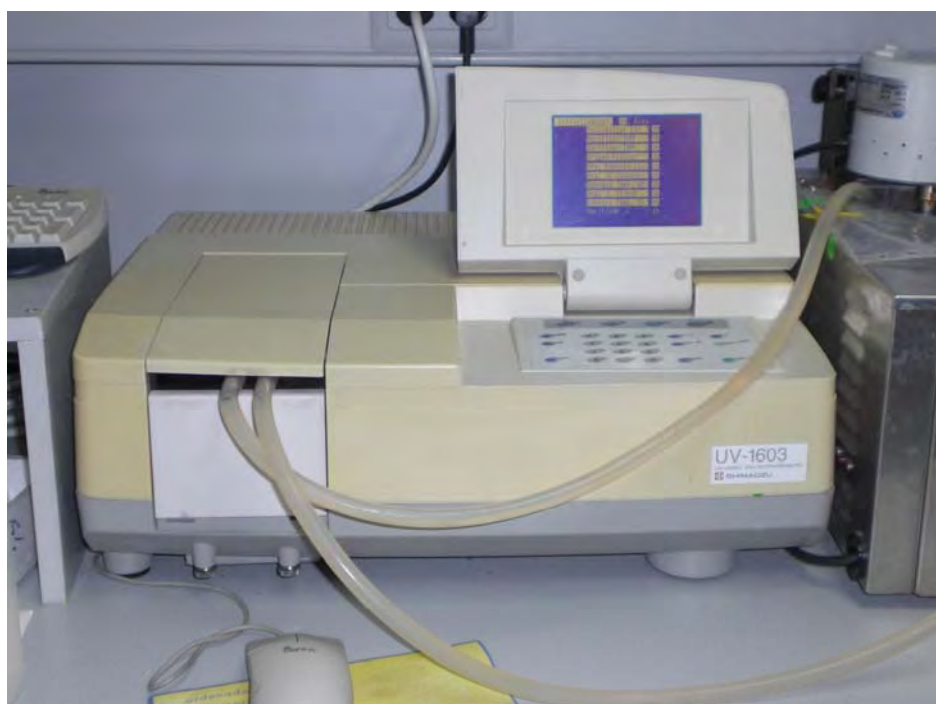
Fotografías MM.17. Espectrofotómetro UV/V de doble haz
