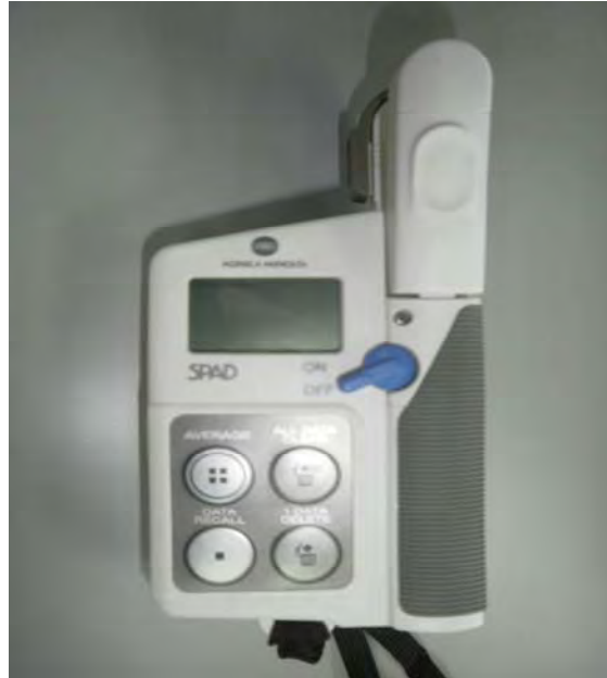
Fotografía MM.8.- Medidor de clorofila Minolta SPAD-502.
