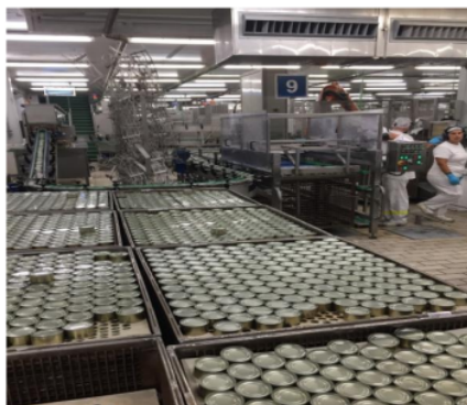
Figura 29. Carros con las latas una vez esterilizadas y preparadas para el etiquetado
