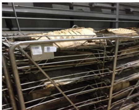
Figura 26. Lomos recién salidos del proceso de cocción con etiquetas de codificación que garantizan la trazabilidad en todo el proceso
