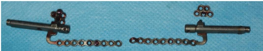
Figura 100: Distractor maxilar izquierdo hallado roto en el momento de la retirada. (figura propia).
