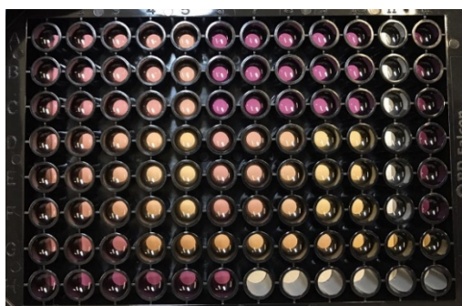
Figura 2.2. Microplaca cargada con muestras de antioxidantes a distintas concentraciones y DPPH • .
