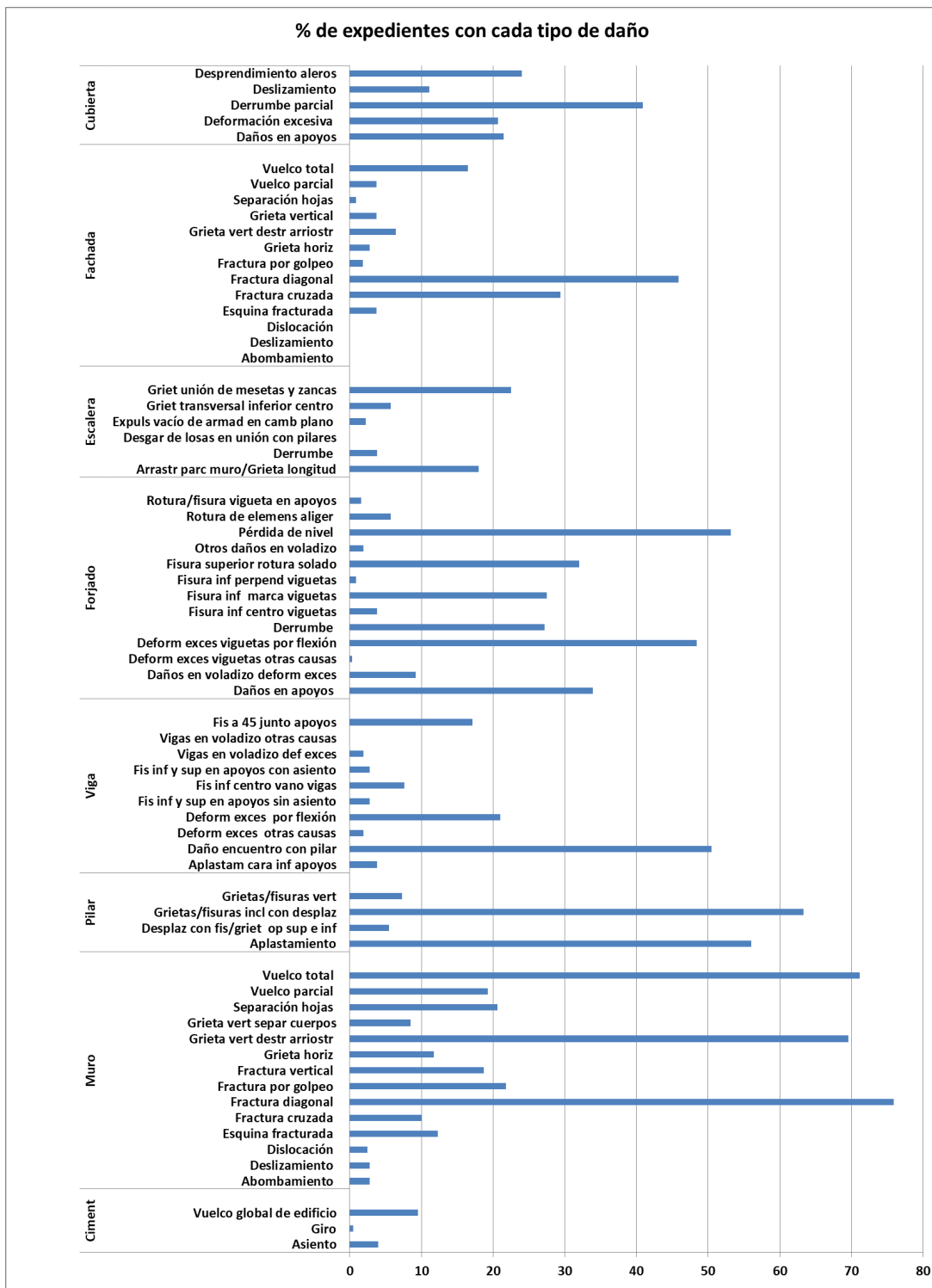
Figura 69 Porcentaje parcial de expedientes en los que aparece cada uno de los tipos de daño
