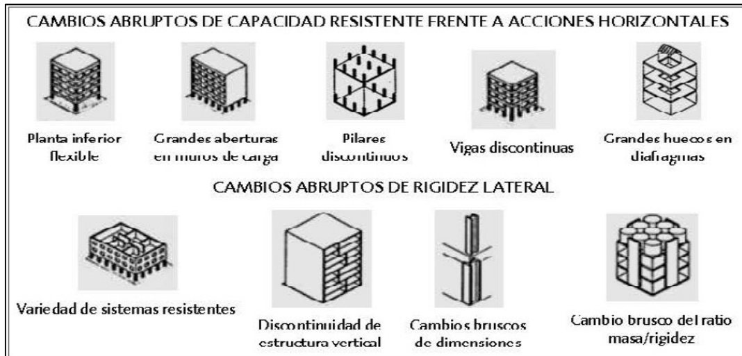
Figura 6 Falta de continuidad en la estructura vertical y cambios de rigidez (Martínez Cuevas, 2014a)
