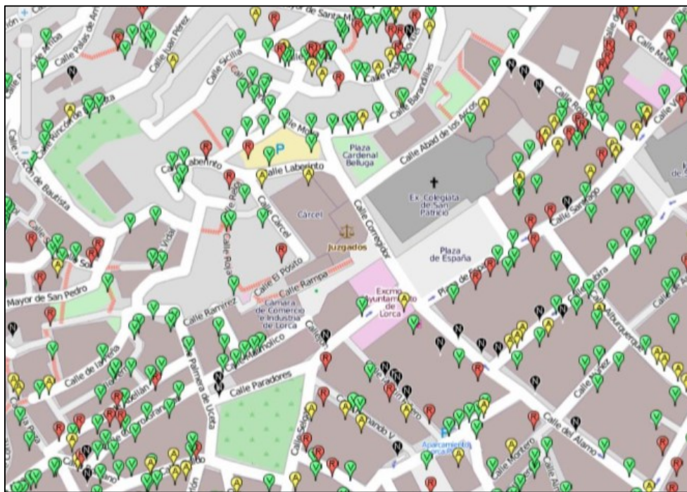
Figura 35 Localización y clasificación de daños tras el terremoto de Lorca (Basset-Salom, L. & Guardiola-Víllora, A., 2014)
