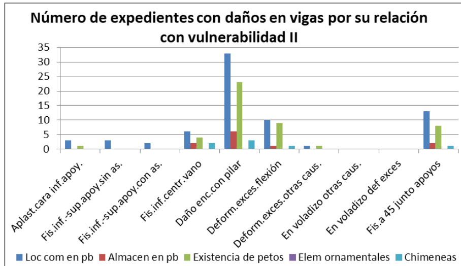
Figura 138 Frecuencia de daños en vigas en función de la vulnerabilidad II
