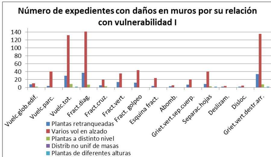
Figura 132 Frecuencia de daños en muros en función de la vulnerabilidad I
