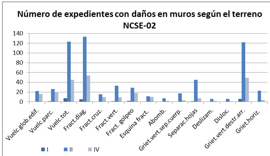
Figura 156 Frecuencia de daños en muros en función del tipo de terreno NCSE-02
