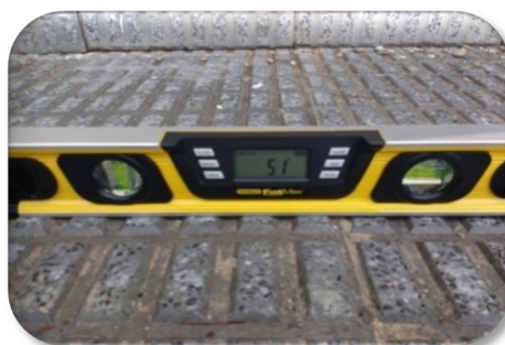
Figura 4.1. Medición de desniveles a través de nivel digital.
