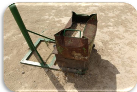
Figura 4.37. Contrapeso en mal estado.
