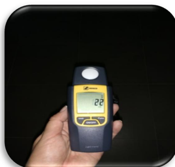
Figura 4.19. Detección de iluminación insuficiente a través de luxómetro.
