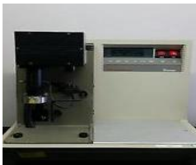
Figura III.8.: Equipo Hi-Res TGA 2950 utilizado en las determinaciones.
