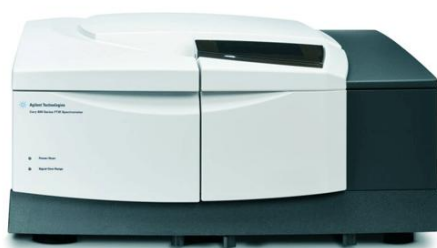
Figura III.9.: Equipo Varian FT-IR 670 utilizado en las determinaciones.
