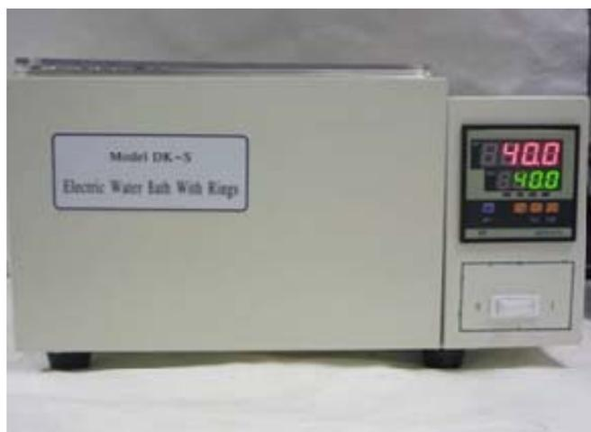
**Figura III.18.** Baño termostatzado usado en los ensayos de envejecimiento acelerado de los materiales compuestos.
