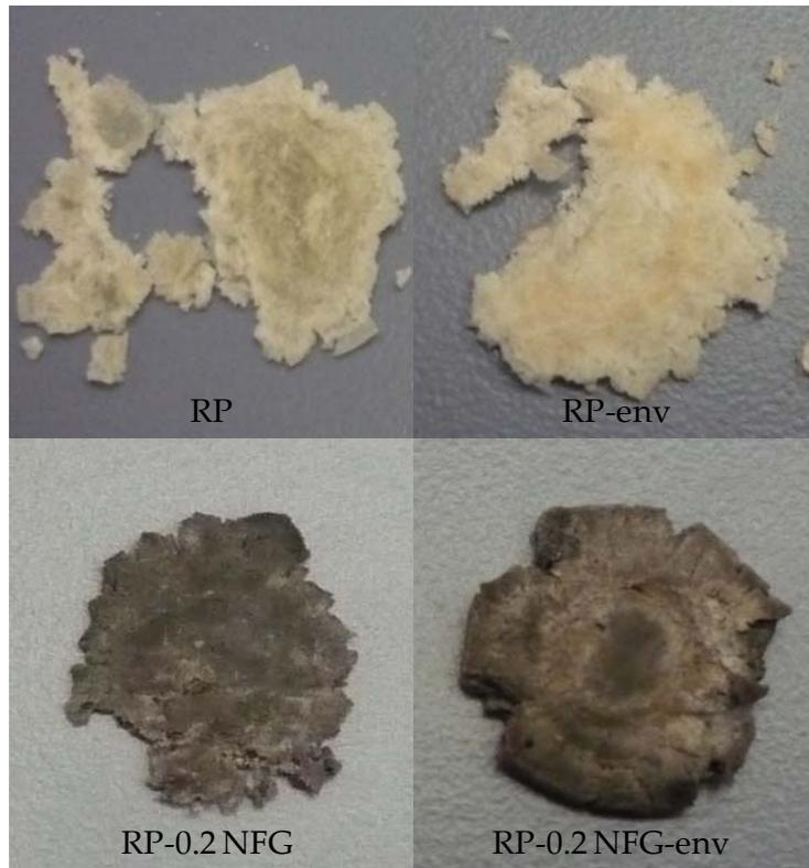
**Figura IV.23b.** Aspecto de los materiales compuestos RP y RP-0.2 NFG, antes y tras envejecimiento acelerado. Ensayos de compresión.
