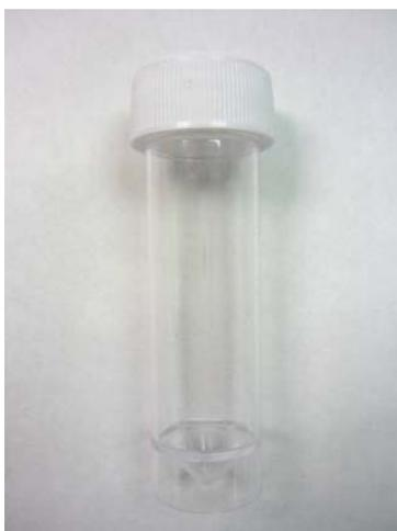
**Figura III.17.** Viales de poliestireno usados en los ensayos de envejecimiento acelerado de los materiales compuestos.
