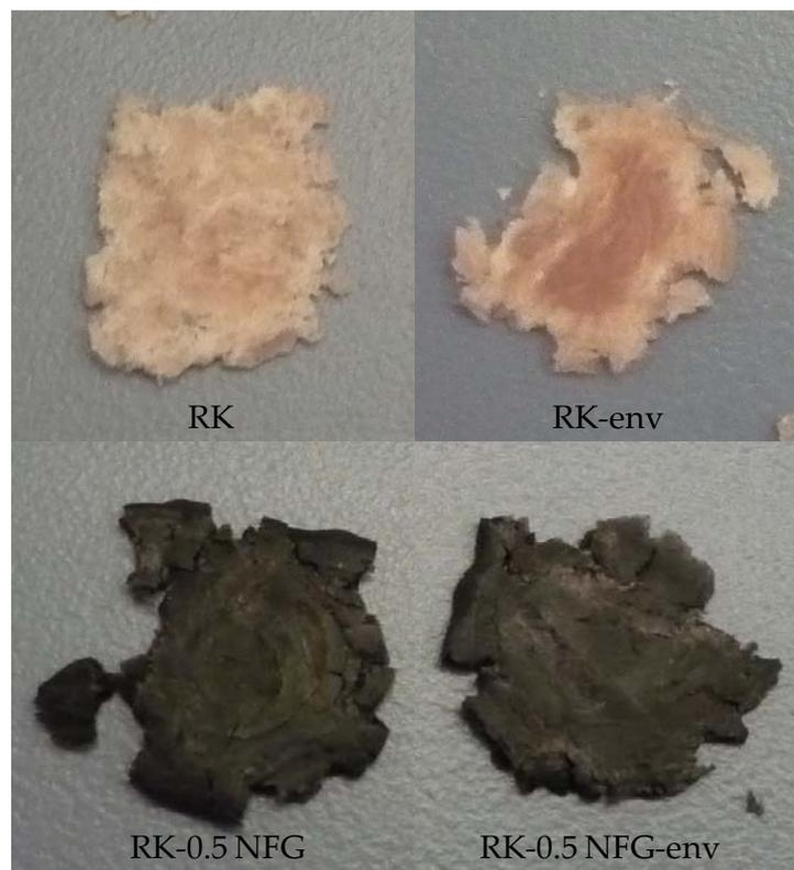
**Figura IV.23a.** Aspecto de los pilares de los materiales compuestos RK y RK-0.5 NFG, antes y tras envejecimiento acelerado. Ensayos de compresión.
