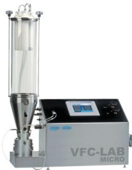
**Figura 4.4.** *Equipo de lecho fluido empleado en los experimentos llevados a cabo en la presente Tesis Doctoral (Freund-Vector VFC-LAB Micro Flo-Coater®).*
