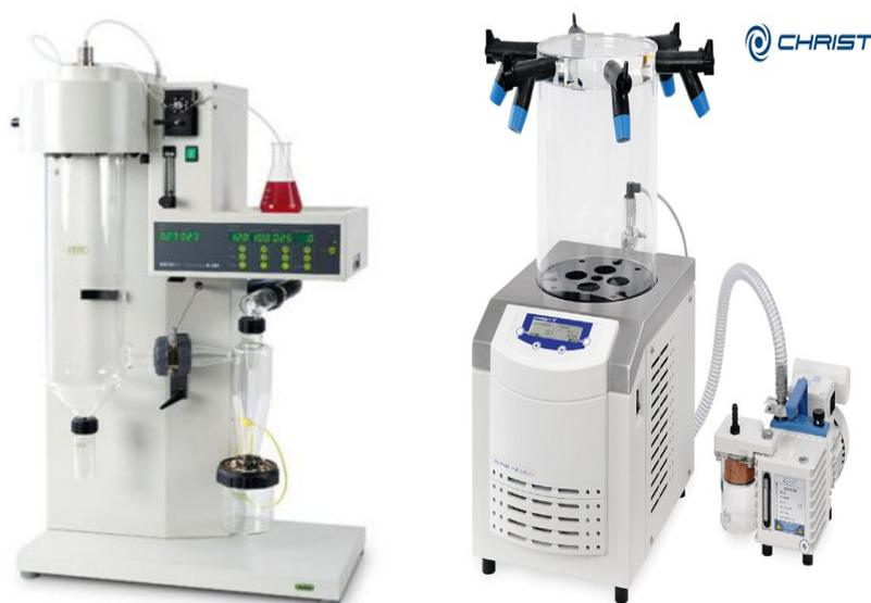
**Figura 4.2.** (A) Secador por aspersión utilizado en los experimentos llevados a cabo en esta Tesis Doctoral (Mini Spray Dryer Buchi B-290). (B) Liofilizador empleado en los experimentos realizados en la Tesis Doctoral (Christ Alpha 1-2 LDplus).
