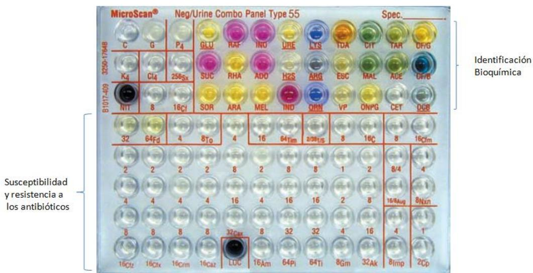
Figura 3.2. Sistema Combo equipo MicroScan Walkaway.
