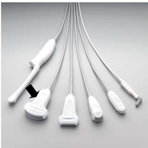
Fig. 19. Transductor cóncavo.
