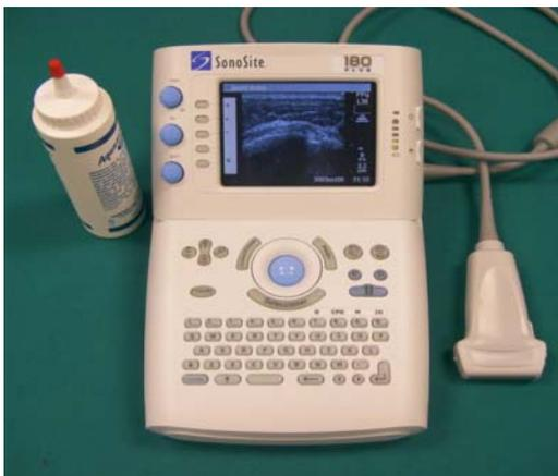
Fig. 109 Ecógrafo portátil, modelo S-180 de Sonosite, junto a la sonda lineal L38/10-5 MHz de 38 mm.
