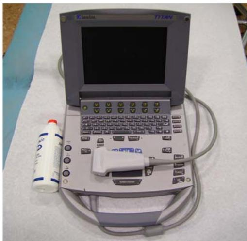
Fig. 110 Ecógrafo portátil, modelo Titan de Sonosite, equipado con la sonda lineal L38/10-5 MHz de 38 mm.
